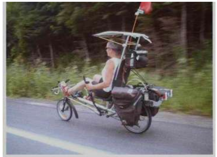
Quetzal technologie allongé 1995 avec son moteur à essence de 0,8hp à l'arrière
